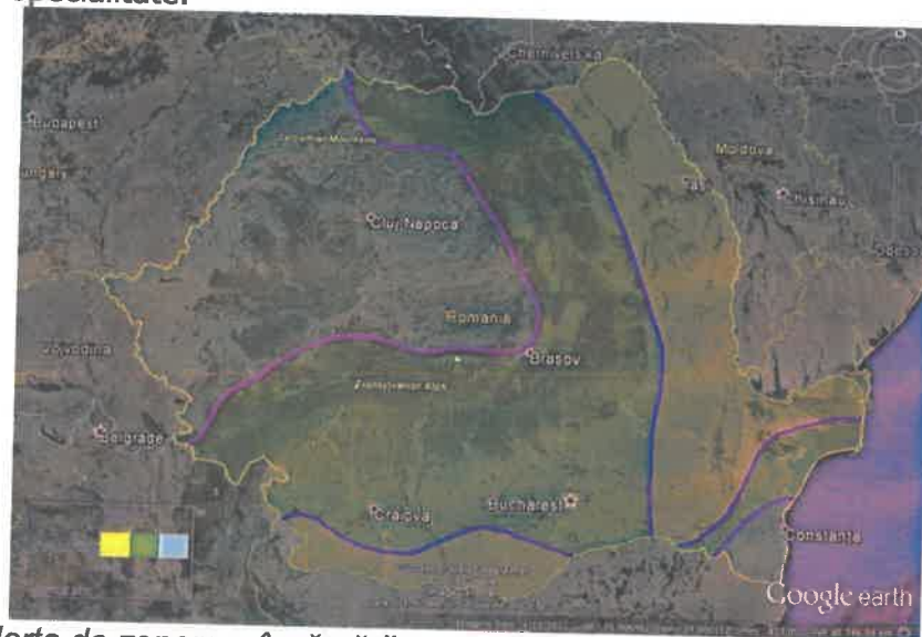
Harta de zonare a încărcării cu zăpadă din codul CR-1-1-3/2012.
